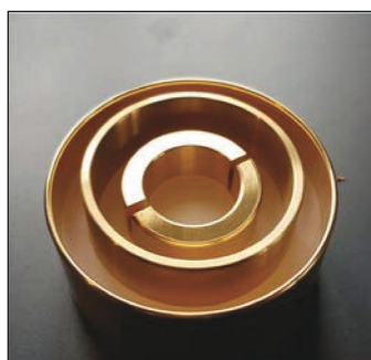
Fig. 8. MDHs unika sändarapplikator, i en version för 1 GHz. Ytterdiameter 86 mm, totalhöjd 34 mm. Matningen sker i de två slitsarna.
